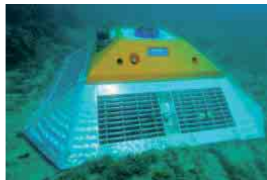
ADCP RDI 600kHz déployé en 2011 dans la réserve de Couronne. Photo : F. Zuberer/Institut Pytheas
